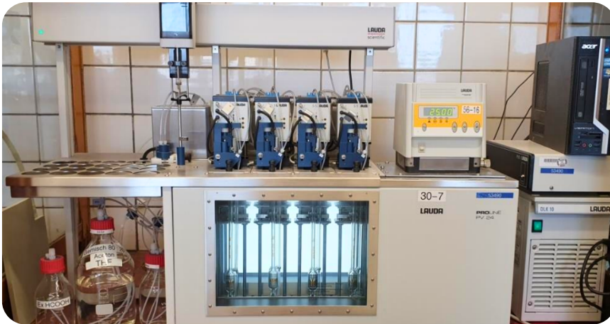
ABB. 1: VOLLAUTOMATISCHES LÖSUNGSVISKOSITÄTS-MESSSYSTEM; ERLAUBT DIE SCHNELLE BEARBEITUNG GROSSER PROBENSERIEN.
