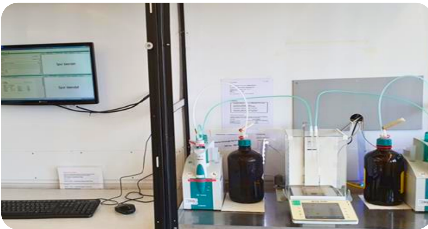
ABB. 2: AUTOMATISIERTES PROBENVORBEREITUNGSSYSTEM; ÜBLICH SIND POLYMERKONZENTRATIONEN VON 0,005 G/CM 3 (0,5 %) UND 0,01 G/CM 3 (1 %).
